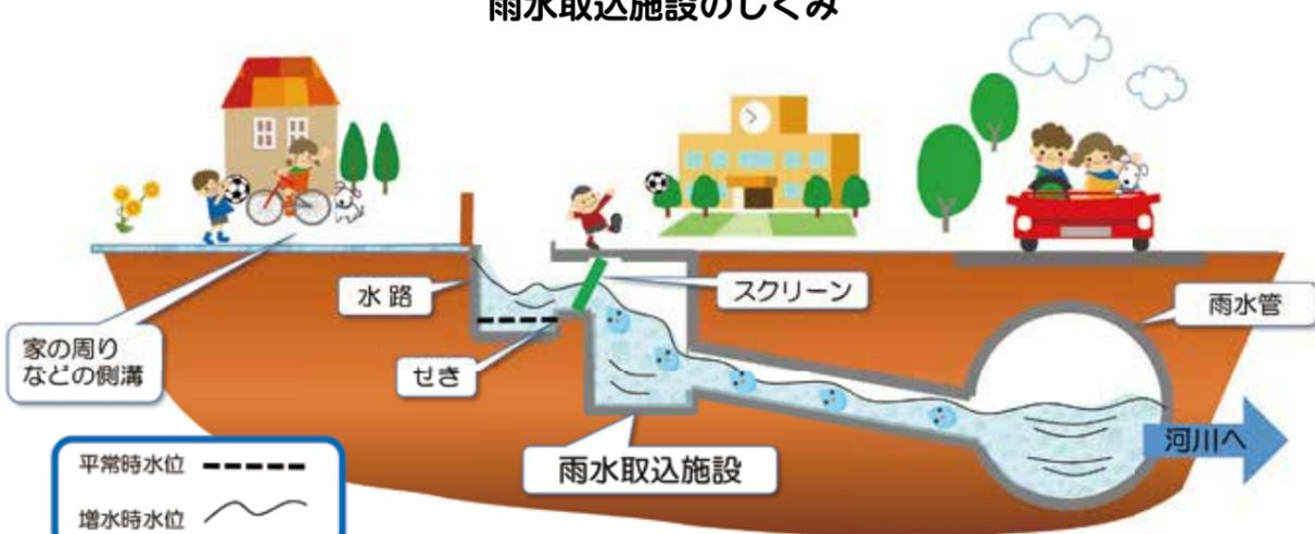
大雨時には、せきを超え、雨水管を経て河川に排出されます
