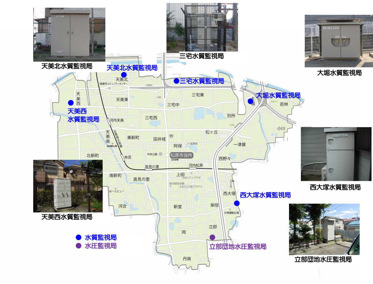
図 5.2.3 水圧・水質監視局設置場所
