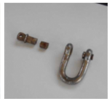
吊り金具破損部詳細
