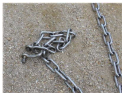
吊り金具破損状況
