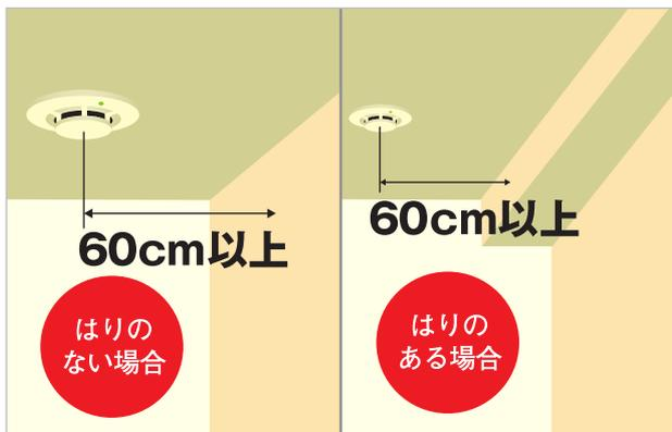
**注意：**火災警報器の中心(感知部)を壁から60cm以上離して取り付けます。天井にはりがある場合には、火災警報器の中心から60cm以上離します。
