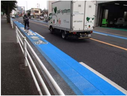
写真 I-2 自転車専用通行帯の事例 (幅の全部をカラー化)
